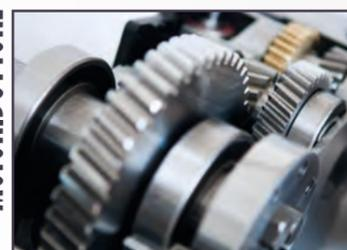
Gioiello di meccanica il motoriduttore completamente realizzato in alluminio, acciaio e bronzo, con tutti gli ingranaggi elicoidali, assemblati su cuscinetti di alta qualità e inseriti su precise sedi lavorate allo scopo di avere una precisione assoluta tra gli assi degli ingranaggi.
