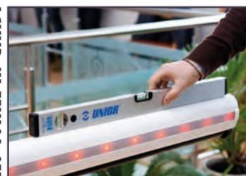
Inclinazione dell'asta direttamente gestibile dalla centrale di comando attraverso parametri che permettono in via digitale di regolare in decimi di grado l'inclinazione dell'asta in apertura e chiusura, durante l'installazione, manutenzione ed utilizzo operativo.
