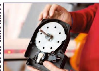
Sblocco manuale meccanico a chiave in grado di sbloccare la barriera in qualsiasi evenienza e situazione grazie alla sua eccellente meccanica basata su ingranaggio e cuscinetto eccentrico di sblocco.
